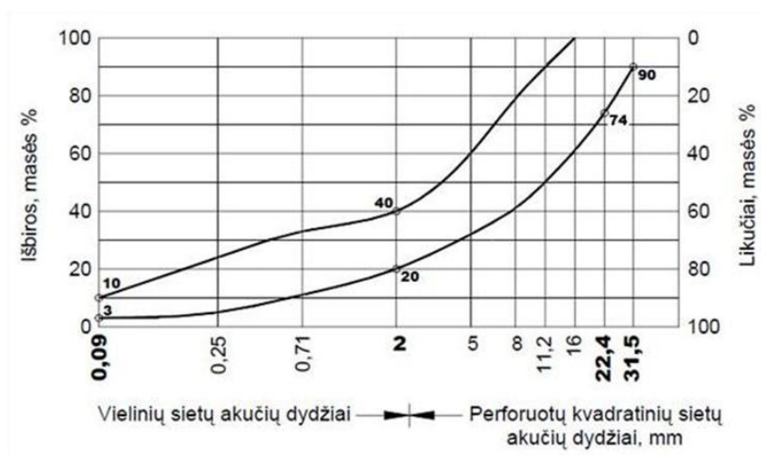
15 pav. C arba CS tipo asfaltbetonio mišinių (0/16 9 ), 0/22, 0/32) mineralinių medžiagų granulimetrinės sudėties sritis
