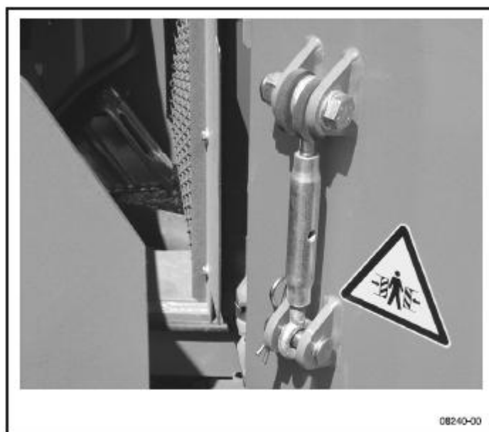
71 pav. Posūkio mechanizmo apsauga neįstatyta
