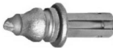
138 pav. Lūžo kietojo metalo dalies galas
