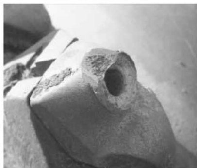
142 pav. Pažeistas frezavimo peilio laikiklis
