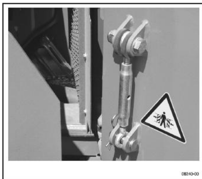
71 pav. Posūkio mechanizmo apsauga neįstatyta
