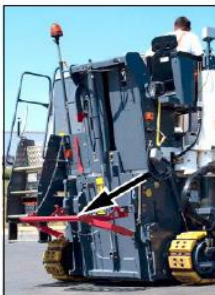
42 pav. Apsauginė įkaba
