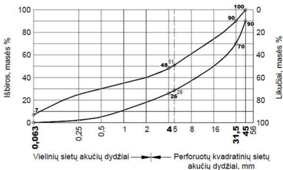
9 pav. Žvyro pagrindo sluoksnių iš mišinio 0/45 granulimetrinės sudėties sritis
