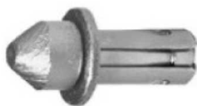
137 pav. Lūžo kietojo metalo dalis
