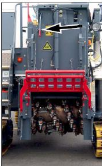
40 pav. Apsauginis kablys tinkamai užfiksuotas
