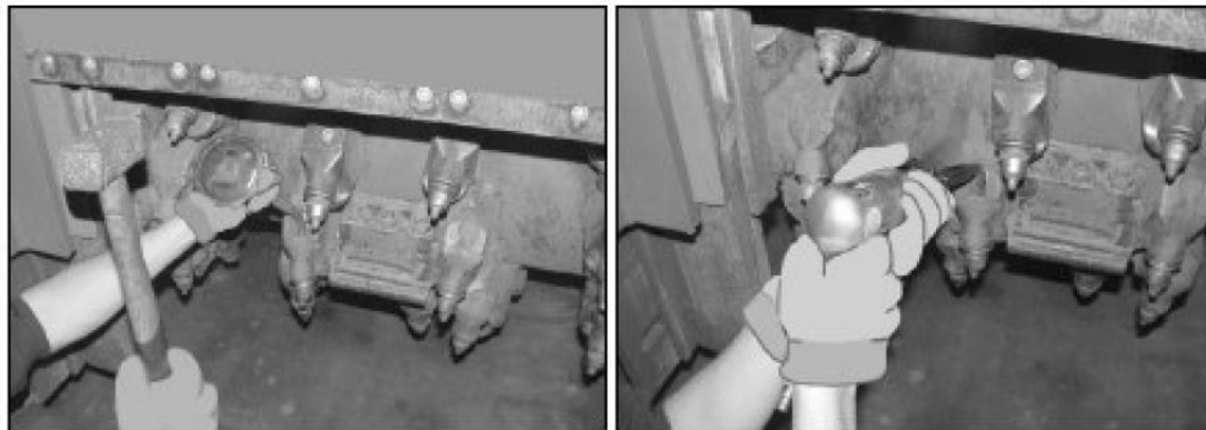
145 pav. Frezavimo peilių išėmimas
