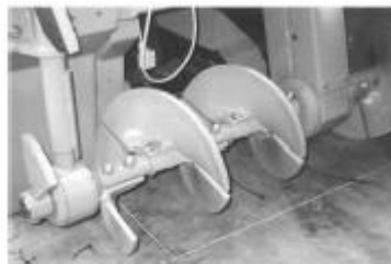
46 pav. Mišinio tiekimo transporteris ir paskirstymo įrenginiai
