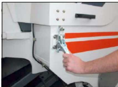
126 pav. Variklio dangčio tvirtinimas
