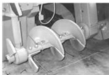
46 pav. Mišinio tiekimo transporteris ir paskirstymo įrenginiai
