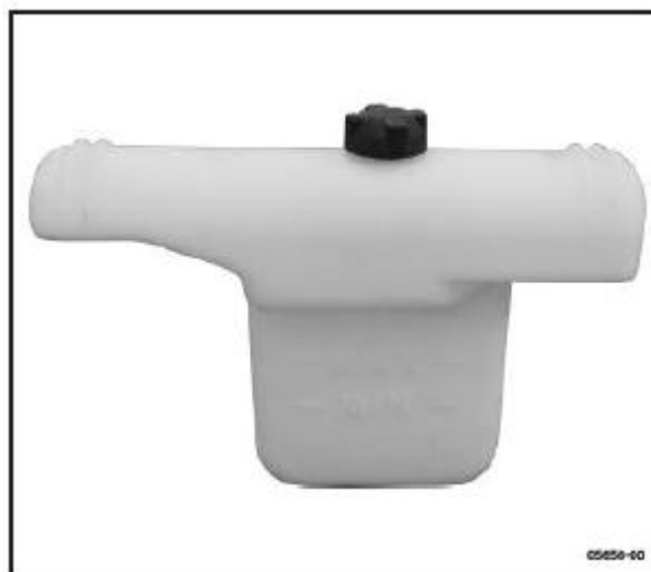
76 pav. Skysčio lygio variklio aušinimo sistemoje patikrinimas
