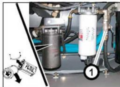
172 pav. Filtro keitimas 2
