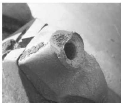
142 pav. Pažeistas frezavimo peilio laikiklis
