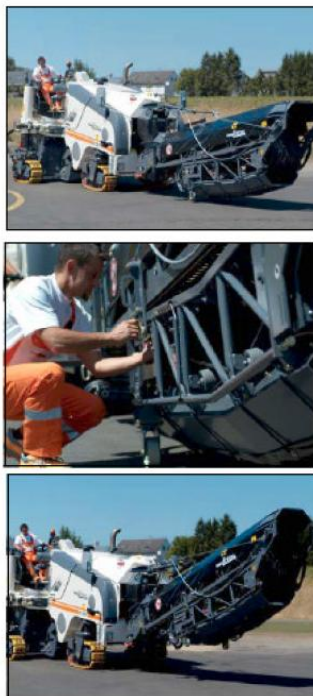
94 pav. Juostinio transporterio ištiesimas
