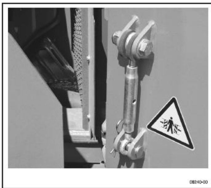
71 pav. Posūkio mechanizmo apsauga neįstatyta
