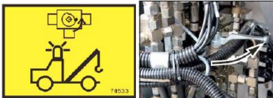
77 pav. Frezos stabdžių suaktyvinimas
