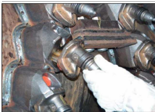
154 pav. RSM sistemos laikiklio išėmimas
