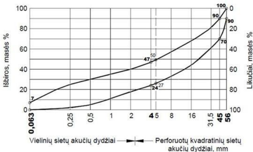
10 pav. Žvyro pagrindo sluoksnių iš mišinio 0/56 granulimetrinės sudėties sritis
