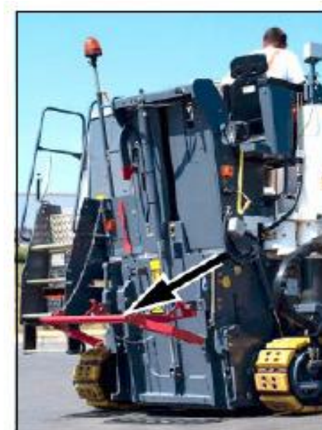
42 pav. Apsauginė įkaba
