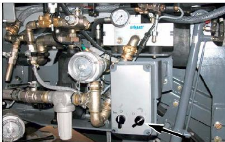
102 pav. Vandens rezervuaro užpildymas įtaisytu vandens siurbliu
